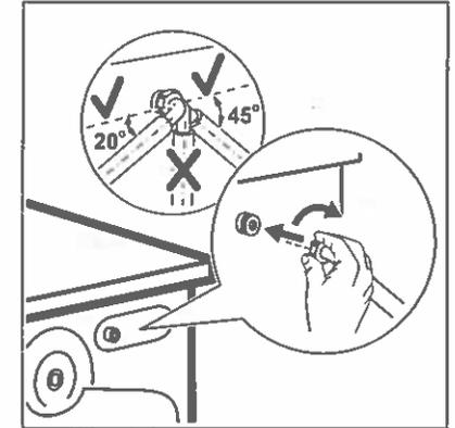
**i** Vergewissern Sie sich, dass sich der Zulaufschlauch nicht in der vertikalen Position befindet.
