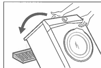
7. Entfernen Sie den Styroporschutz von der Geräteunterseite.
