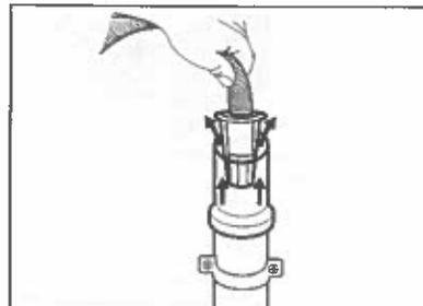
5. Ohne Kunststoffführung in einen Siphon - Stecken Sie den Ablaufschlauch in den Siphon und befestigen Sie ihn mit einer Schlauchschelle. Orientieren Sie sich an der Abbildung.
