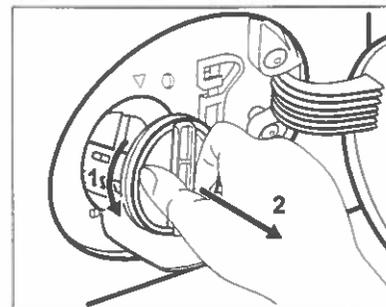
7. Schließen Sie den Ablaufkanal und drehen Sie das Sieb gegen den Uhrzeigersinn, um es zu entfernen.
