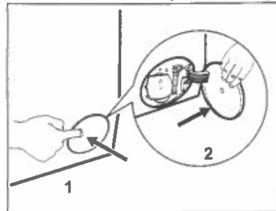
2. Stellen Sie einen geeigneten Behälter unter die Öffnung der Ablaufpumpe, um das abfließende Wasser aufzufangen.
