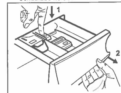
2. Entfernen Sie das Oberteil des Pflegemittelfachs, um die Reinigung zu vereinfachen, und spülen Sie es mit fließendem warmem Wasser aus, um das angesammelte Waschmittel zu beseitigen. Setzen Sie nach der Reinigung das Oberteil wieder ein.
