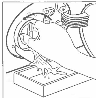
5. Wenn der Behälter voll ist, schließen Sie den Ablaufkanal und leeren Sie den Behälter.
