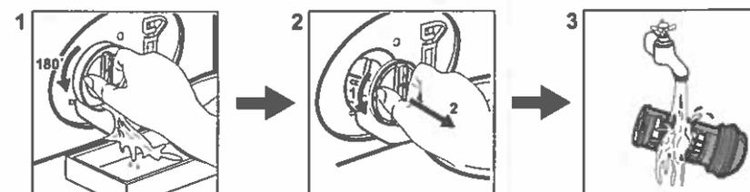
Reinigen Sie das Sieb regelmäßig und insbesondere, wenn der Fehlercode **E20** im Display angezeigt wird.
