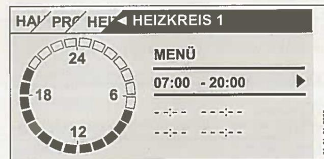
Sie können pro Tag oder Zeitblock drei Schaltzeitpaare einstellen. Die Schaltzeitpaare werden in der Anzeige rechts neben der Uhr aufgelistet. Jedes Schaltzeitpaar besteht aus einer Start- und einer Endzeit.
