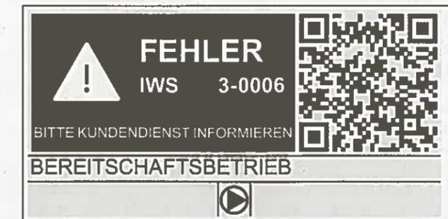
Wenn mehr als ein Fehler auftritt, wird stets der zuletzt aufgetretene Fehler angezeigt.
